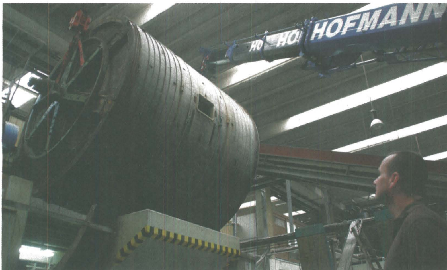
Nicht viel Platz für die Schwerlastkräne: Heller-Leder-Geschäftsführer Thomas Strebost beobachtet den aufwendigen Tausch der Gerbfässer in der Produktionshalle. Fotos: Il
